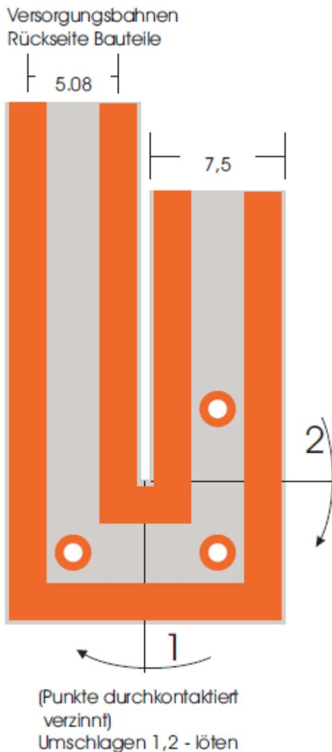
Dabei werden die Leiterplatten am Umschlagpunkt mit jeweils 3 Löt- oder Nietpunkten versehen. Auch das Anbringen von doppelseitigem 3M-Klebeband an den Knickstellen ist durch uns möglich. Nach Ausschnitt der flexiblen Leiterplatten, können diese dort gefaltet und miteinander verbunden werden. Sollte eine Vernietung aufgrund höherer Kräfte bevorzugt werden, so sind zusätzliche Verstärkungen am Faltpunkt möglich.
